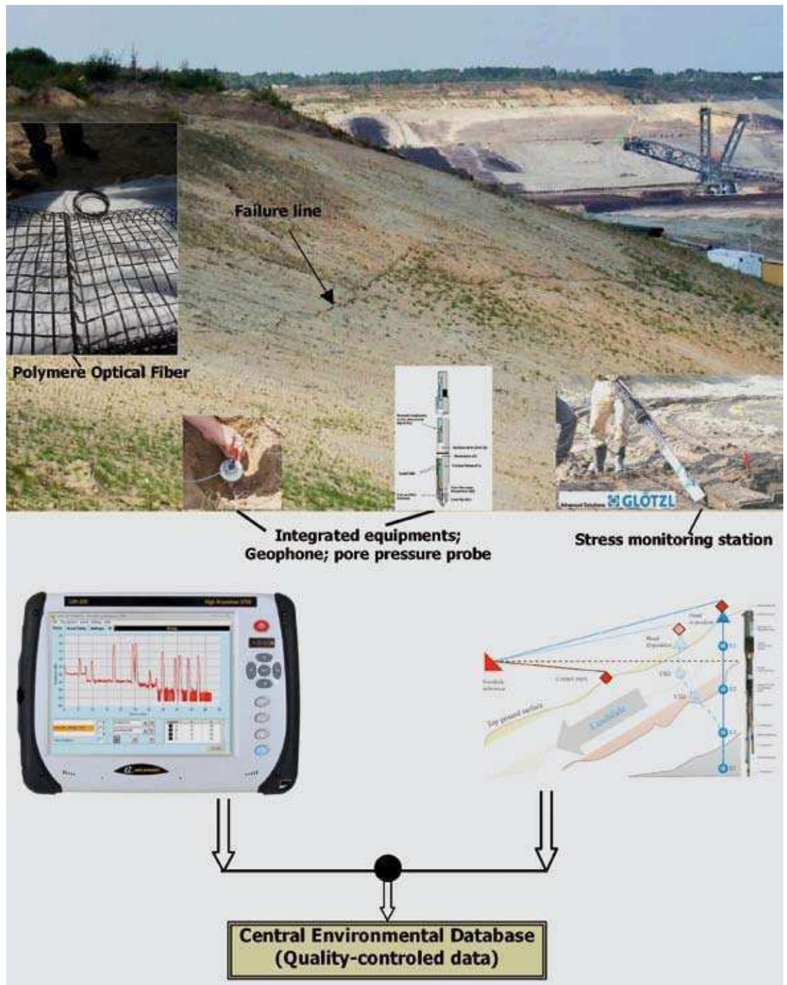
Bild 15. Prinzip einer Monitoringstation mit zentraler Datenerfassungs- und Auswertungseinheit (Umweltdatenbank) und Frühwarnsystem, zum Teil in Belchatov-lignite mine/Poland angewendet (GLÖTZL et al., 2009).
