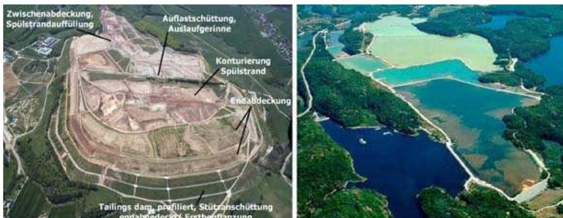
Bild 6. Abdeckungen von Tailings Ponds aus dem Uranbergbau, links Tailings Ponds Trünzig der Wismut GmbH trockener in situ-Verwertung (Quelle: LERSOW, Wismut GmbH, 2007); rechts mit Klarwasserlamelle abgedeckte Tailings Ponds Rio Algom Quirke site Elliot Lake/OntarioCanada (BHP Billiton, 2004).
