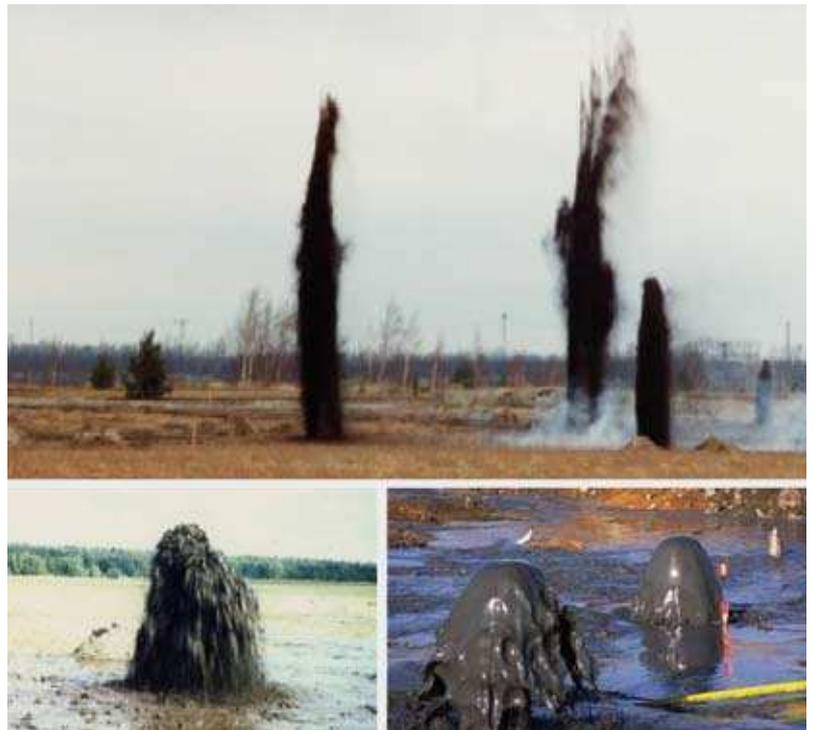
Bild 5. Porenwasserfontänen nach Entlastung, oben Sprengverdichtung Kippenareal in der Lausitz, unten links teilweise gefülltes Tagebaurestloch, unten rechts Vertikaldräns in Feinschlamm-tailings (Quelle: LERSOW).
