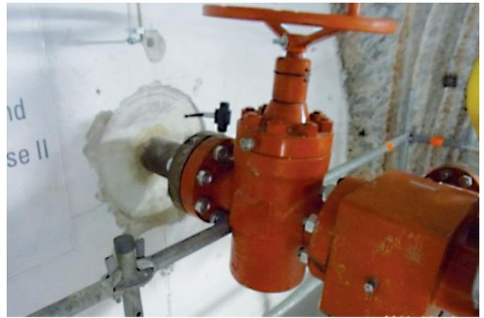
Bild 3: Schachtanlage Asse II; Maschinenhaus (links); Faktenerhebung, Bohransatzpunkt mit Preventer (rechts); Fotos: M. Lersow
